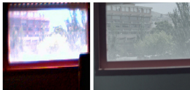
Fig. 3. Diferencia entre la captura de una escena de alto contraste luminoso, por un sensor CMOS normal y otro logarítmico.
